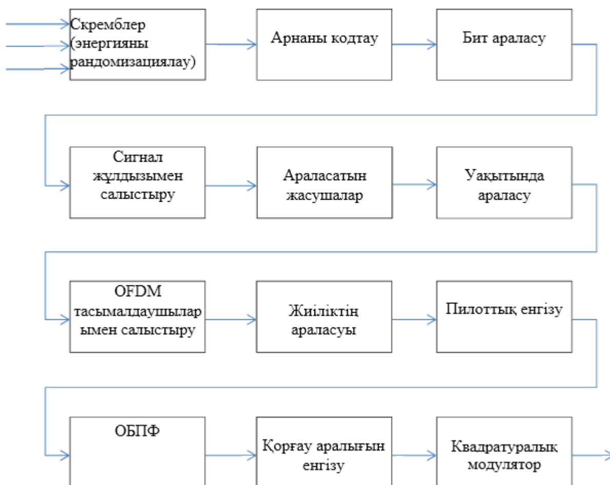
1.1-сурет - Сигналдарды қалыптастыру жолының жалпыланған құрылымдық схемасы цифрлық хабар тарату жабдықтары
